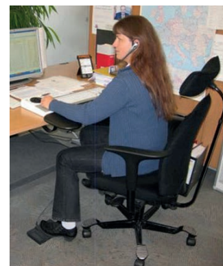
Angepasster Bildschirmarbeitsplatz: Headset für Spracheingabe, Fußtaster für Mausclick, Sonderstuhl, Tastatur mit Trackball
