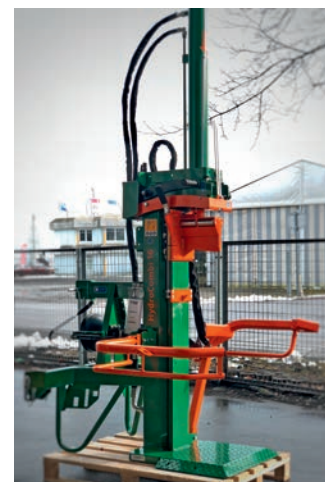
Neue vertikale Spaltmaschine für Meterholz
